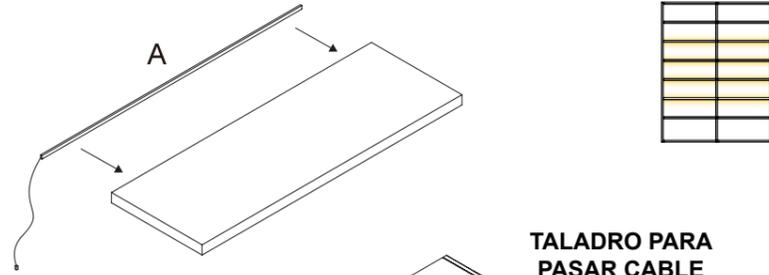
2 Montar los elementos Addbox separados de la pared y taladrar la trasera para pasar el cable del led.
